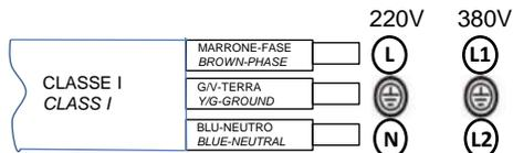
**Collegamento modulo alimentazione al corpo illuminante (per versioni REV0xB0-REV0xK0)**
